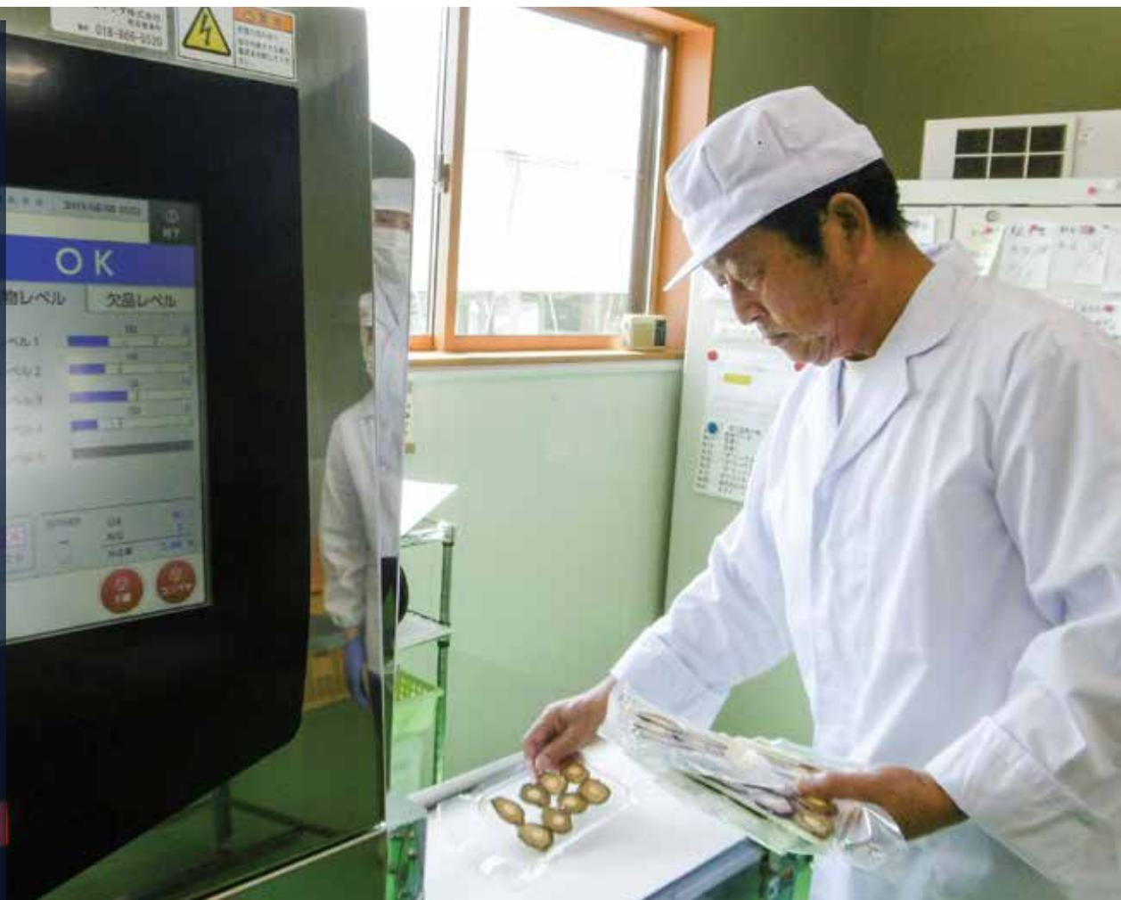
導入したX線検査装置を活用する様子
